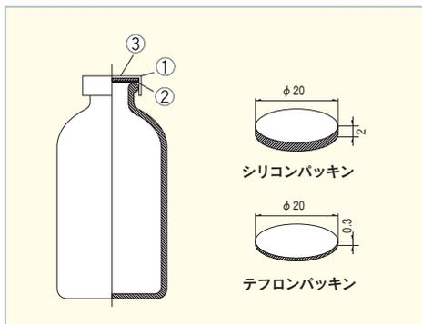
当社のバイアル瓶用シリコーンゴムパッキン及びテフロンパッキンは、市販のアルミシールにすぐ装着できるよう、丸型形状に型抜きしています。従来からテフロンシートはハサミでカットしていますが、このパッキンを使用すると、シール作業が迅速に行えます。又、厚みも、気密性を考慮して製作しているため試料のもれが全くありませんので安心してご使用いただけます。
