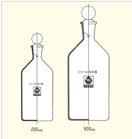
トリハロメタン (TH) 用採水瓶は、まさに時代のニーズによって誕生した新しいタイプの採水瓶です。TH用検水は、栓をした状態でエアーが残らないこと、又、栓を開ける時陰圧にならないことが、絶対条件です。弊社が考案したTH用採水瓶は、この点を完全にクリアした理想的な採水瓶です。栓は、エアーを抜くため頻繁に回すので回しやすい形状になっております。
