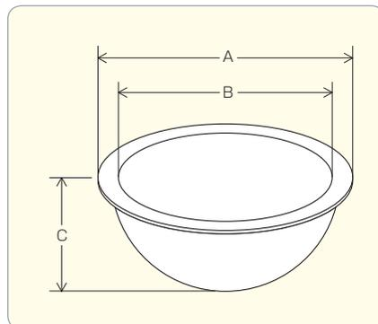
■ 規格 (蒸留装置用金属製加熱皿 / 原板常用温度 1000 )
