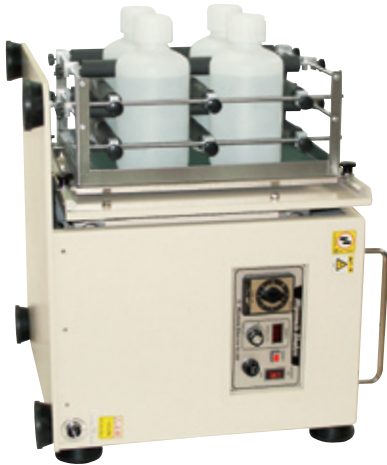
(2Lポリびん使用例) MW-GS ヨコ振とう状態 振とう容器ホルダー付き(ポリ瓶は付属しません)
