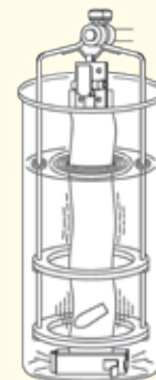
セロハンチューブに振動を与える。 最下位位置
